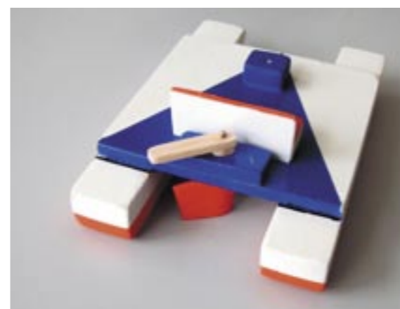
Detail uložení hotového kormidla
